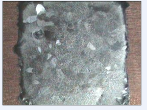
整形后具有晶格斑纹的焊料图 4
