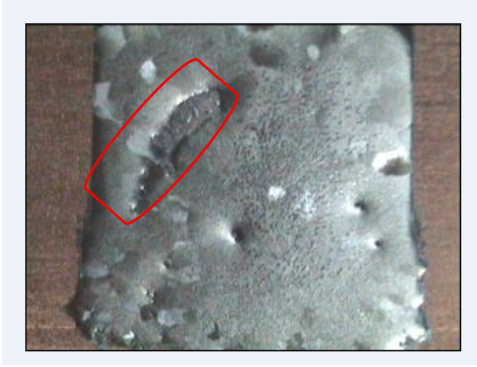
整形后引线框上有空洞 图 3
